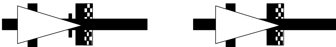
Figura 2: Posição válida (esquerda) e inválida (direita) dos robôs na linha de partida
